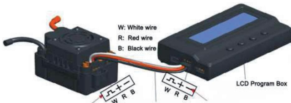
Mit dem Program Port der LCD Program Box verbinden.
